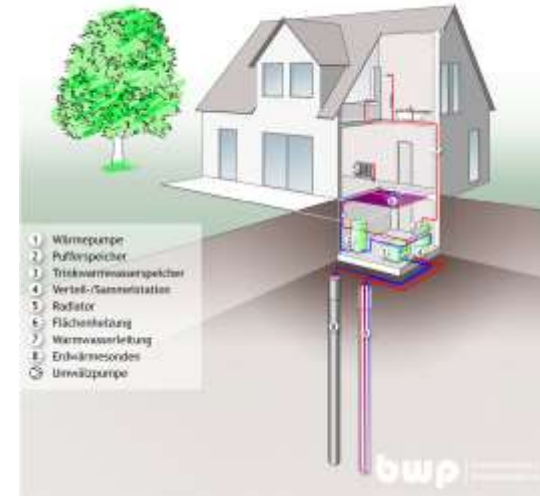
Wärmepumpe mit Erdwärmesonden
