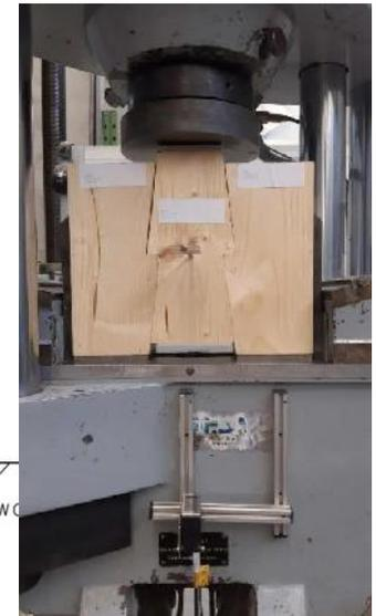
Abbildung 4.3 Variante mit sich verjüngenden Flanken der Schwabenschwanz-Verbindung
