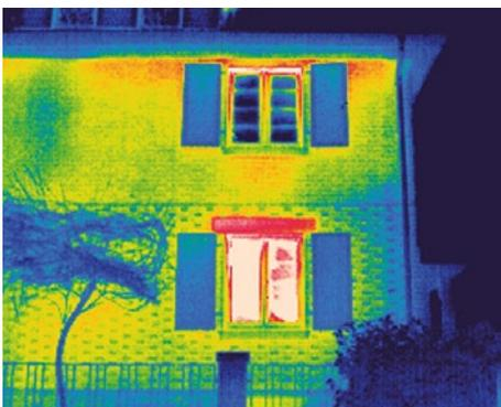
Abb. 36: Erhöhter Wärmeabfluss im Bereich des Fenstersturzes durch Thermografie sichtbar gemacht
