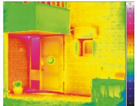
**Abb. 37:** Wärmebrücke im Bereich einer Hauseingangstür
