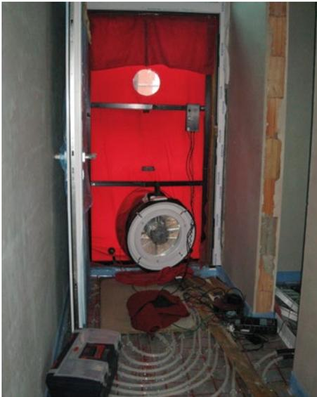
**Abb. 39:** Vorbereitung eines Luftdichtheits-tests an einer Außentür
