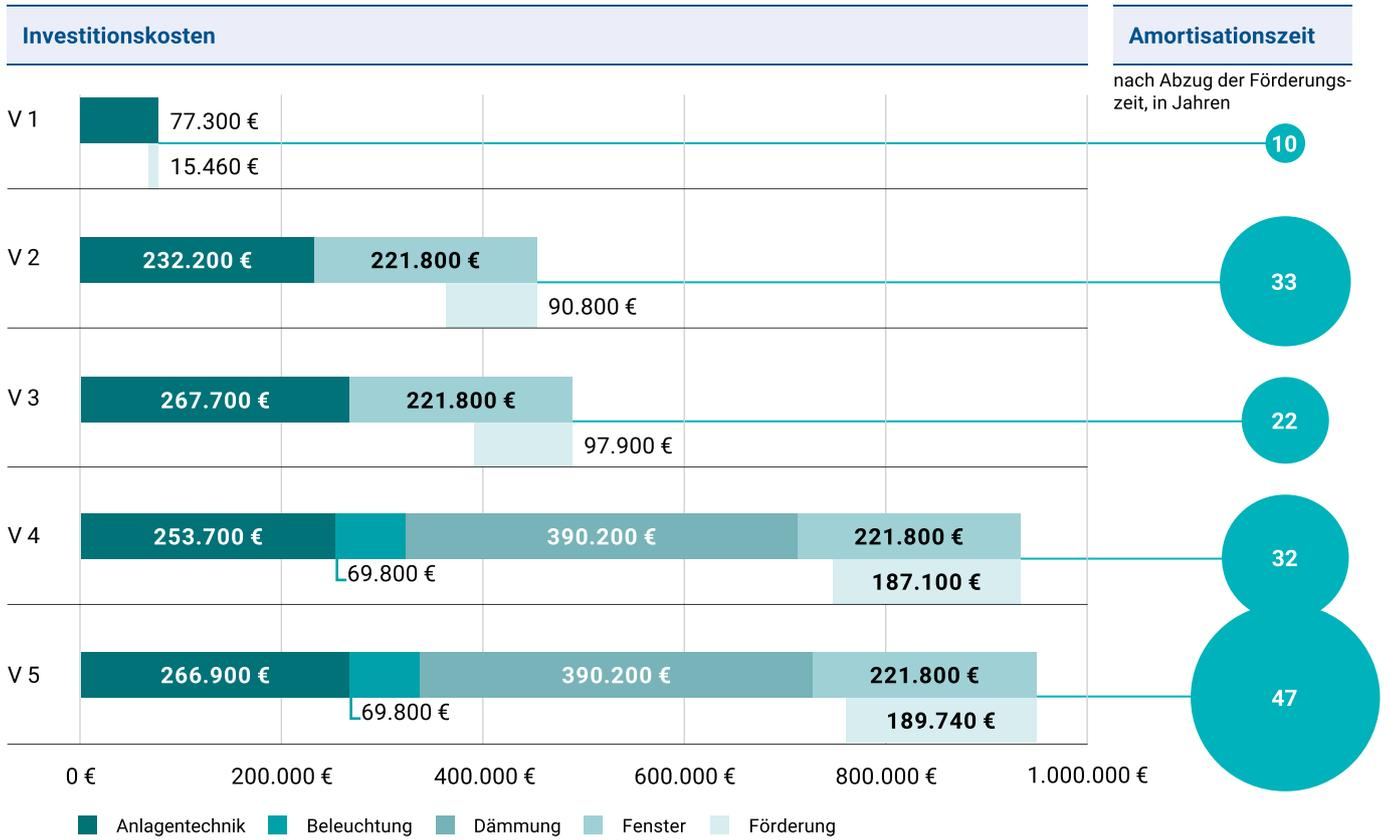
Das Balkendiagramm zeigt für jede Variante die berechneten Investitionskosten für Maßnahmen an der Anlagentechnik, der Dämmung und den Fenstern. Zusätzlich sind die Höhe der Förderung sowie die Amortisationszeit in Jahren angegeben.
