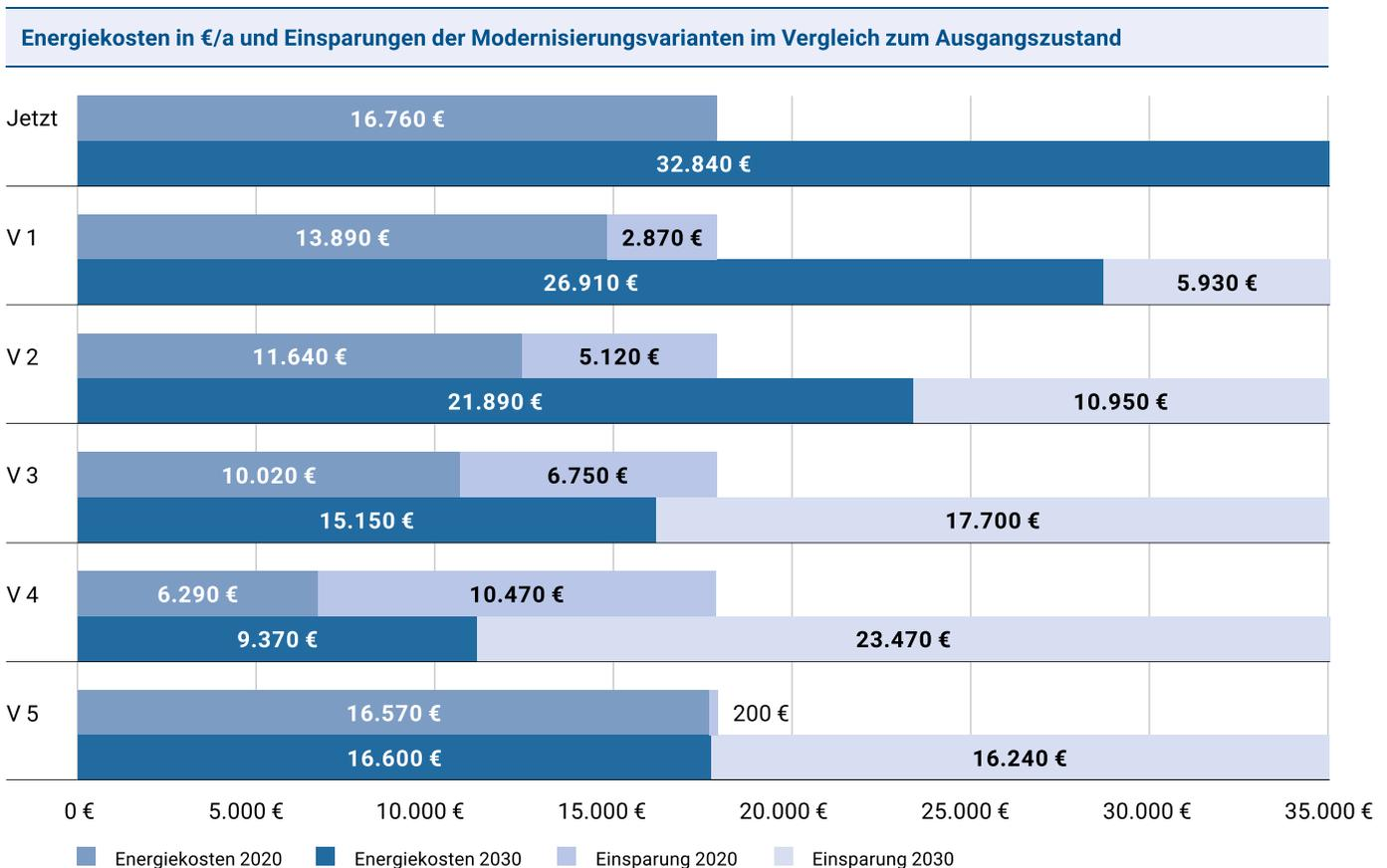
Das Balkendiagramm zeigt für jede Variante die prognostizierten jährlichen Energiekosten (in €/a) für Energiepreise in den Jahren 2020 und 2030 sowie die möglichen Einsparungen gegenüber dem Ausgangszustand.
