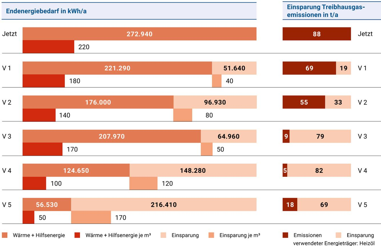
Das Balkendiagramm zeigt für jede Variante die jährlichen Endenergieverbräuche in kWh/a und die zugehörigen Treibhausgasemissionen in t/a an sowie die möglichen Einsparungen gegenüber dem Ausgangszustand.
