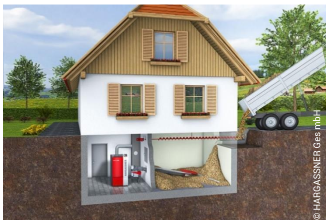
Abbildung 1: Hackschnitzelkessel mit Lager und Austragung
