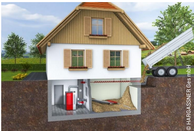
Abbildung 1: Hackschnitzelkessel mit Lager und Austragung
